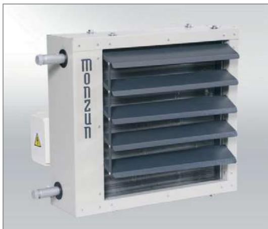
Тепловоздушные агрегаты MONZUN с водяным теплообменником предназначены для экологичного отопления и проветривания помещений и цехов нагретым воздухом. Изготавливаются агрегаты в трех размерах с использованием от однорядных до четырехрядных теплообменников с осевым или центробежным вентилятором. Лицевая сторона имеет регулируемые жалюзи.
