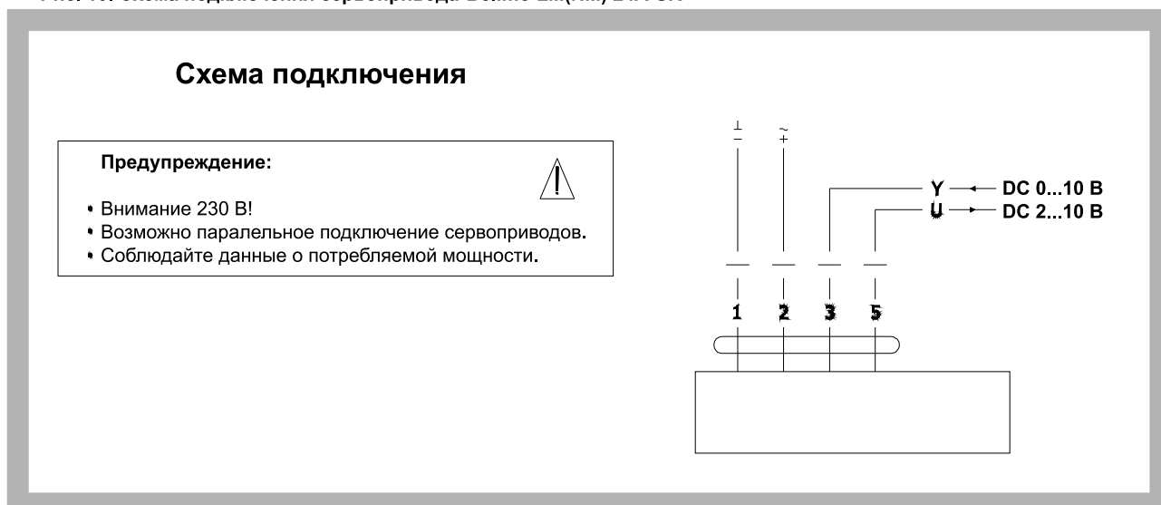
Рис. 10. Схема подключения сервопривода Belimo LM(NM) 24A-SR
