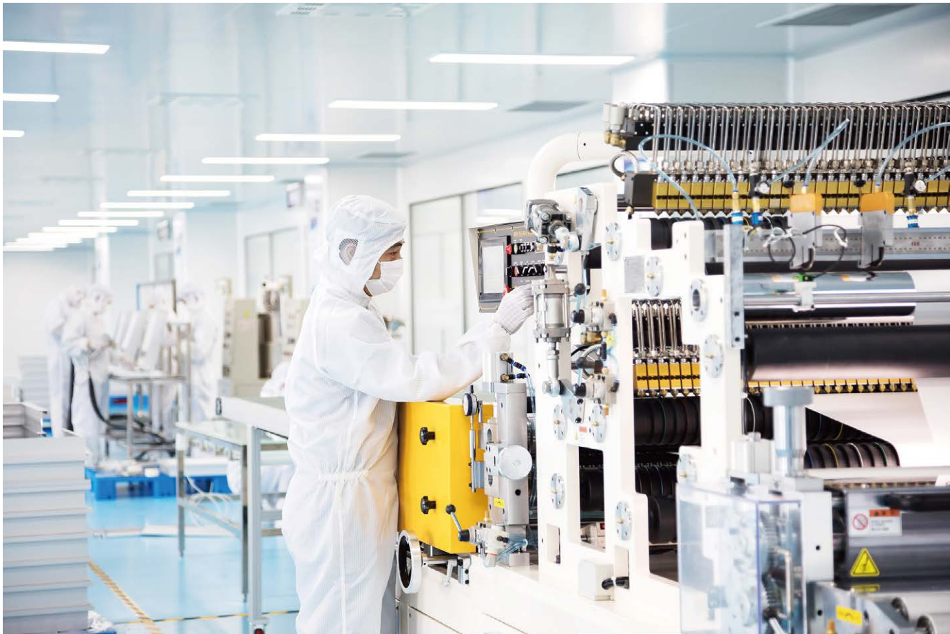
Импортная линия по производству фильтров HEPA ▲
